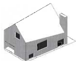
7 Casa di campagna in legno / Wooden country house 358,09 mq / sqm, struttura e rivestimento in legno, copertura in ardesia su base di cemento / timber frame structure with wooden cladding, slate roof on a concrete base
